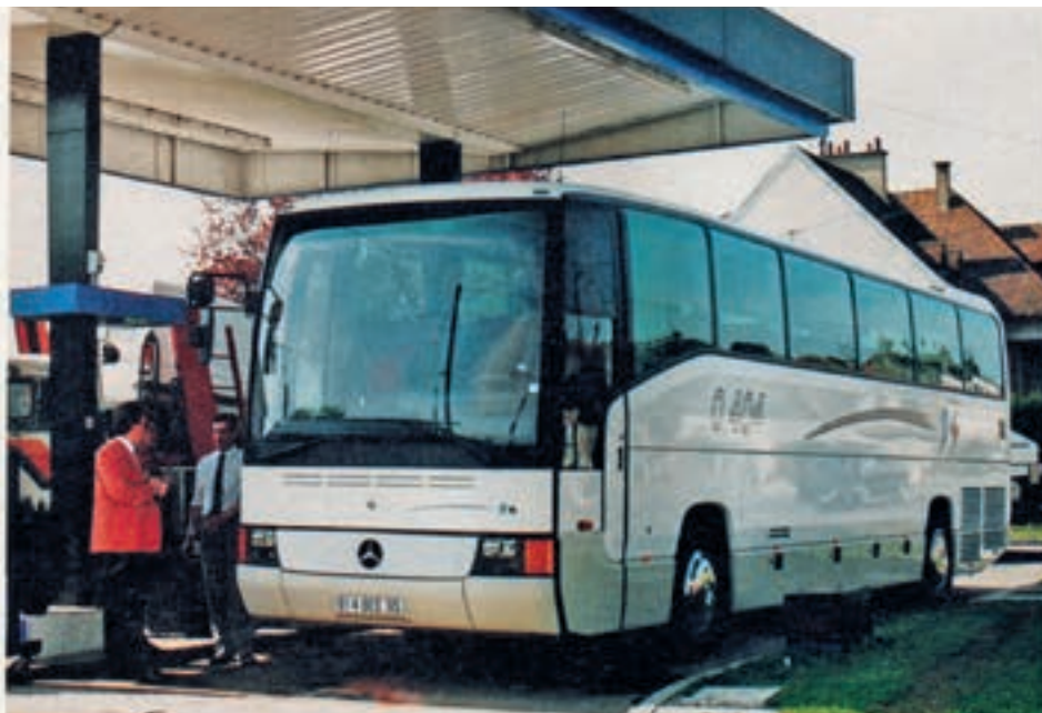
Outre la souplesse de la suspension, le confort du O404 passe par une insonorisation haut de gamme dû en partie par la fluidité de ses lignes et d'un double vitrage.
