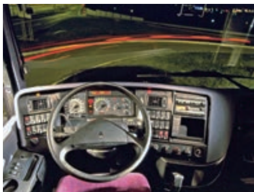
Chronotachygraphe à disque papier, levier de vitesses traditionnel, absence d'écran GPS et d'aides à la conduite, le poste de conduite des premiers Iliade nous replonge dans les années 1990.
