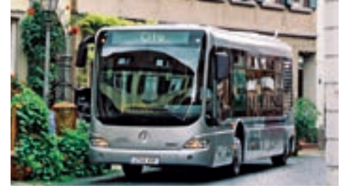
Mercedes tente audacieusement de renouveler les midibus avec l'O520 Cito dont l'une des originalités est la transmission électrique, le moteur thermique placé verticalement à l'arrière et l'absence de porte-à-faux. Sa commercialisation commencée en 1999 s'arrête en 2003.
